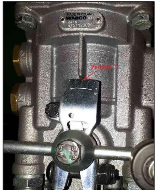
Nastavení pneumatických brzd s automatickým snímáním zatížení ventilem
