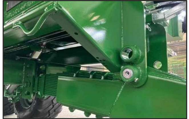
Tažné zařízení s podélnou pružinou Podélné nastavení výšky oje
