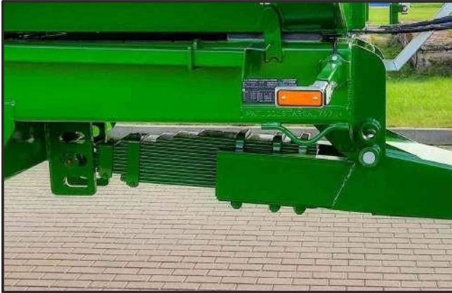
Tažné zařízení s podélnou pružinou Podélné nastavení výšky oje
