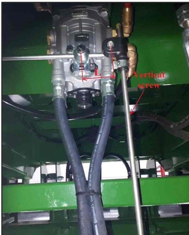
Nastavení pneumatických brzd s automatickým snímáním zatížení ventilem
